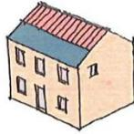
Les panneaux peuvent être considérés comme un matériau de couverture et couvrir un pan total de la toiture.
