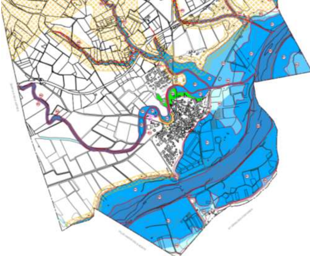
Risque inondation (bleu et vert) et risque mouvement de terrain (jaune) à proximité de la zone urbaine
